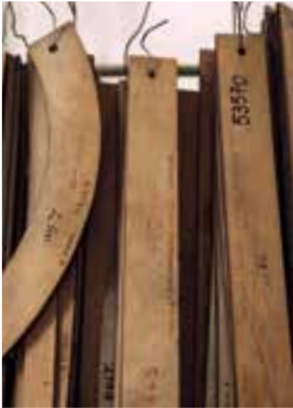
Dime di taglio Giorgetti per la sezionatura e la trasformazione delle assi di legno in semilavorati.
